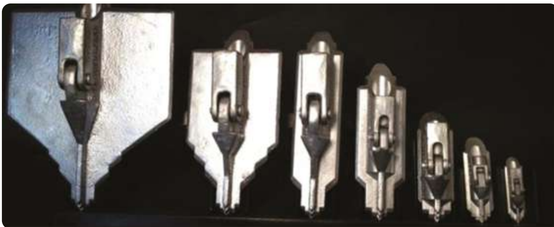
Exemple : les ancrages Manta Ray® sont des systèmes d’ancrage insérés et verrouillés dans le sol, résistants à des efforts d’arrachement, d’une capacité ultime de 180 kN. Il y a six types d’ancres Manta Ray® adaptées aux capacités de retenue souhaitées (de 1 à 8 tonnes). Toutes les Manta Ray® sont en acier galvanisé ; elles peuvent être enfouies à la profondeur désirée.
