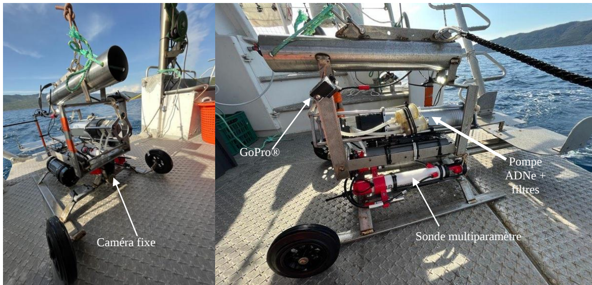
Figure 6 : Photo du traineau d'échantillonnage (prototype) prêt à être envoyé pour commencer un tronçon. La caméra fixe, la sonde, la pompe d'ADN environnemental équipée des deux filtres et une des GoPro y sont visibles.
