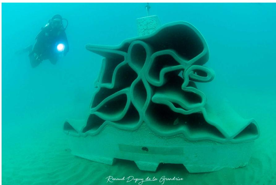
Lest de balisage des 300 m éco-conçu imprimé en 3D (Source : Aire Marine Protégée Cap Agathoise, Seabooast)
