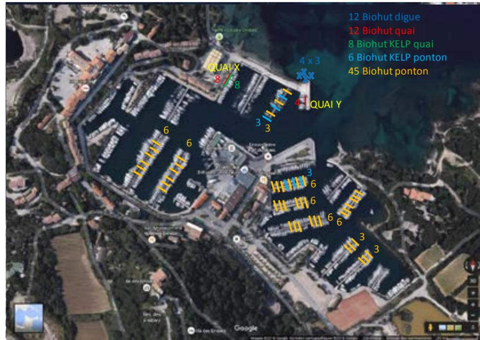
Une partie des actions restauratives du programme SAR-LAB a consisté à équiper des sites en en micro-récifs artificiel (Biohut) afin de réhabiliter la fonction de nurserie par l'apport d'aménagements artificiels qui permettent d'augmenter la capacité d'accueil pour les poissons et pallier le manque d'habitats naturels. Ces actions de réhabilitations ont été réalisées dans les ports des Embiez et du Brusco ainsi que dans l'ancien parc mytilicole de la lagune du Brusco.
