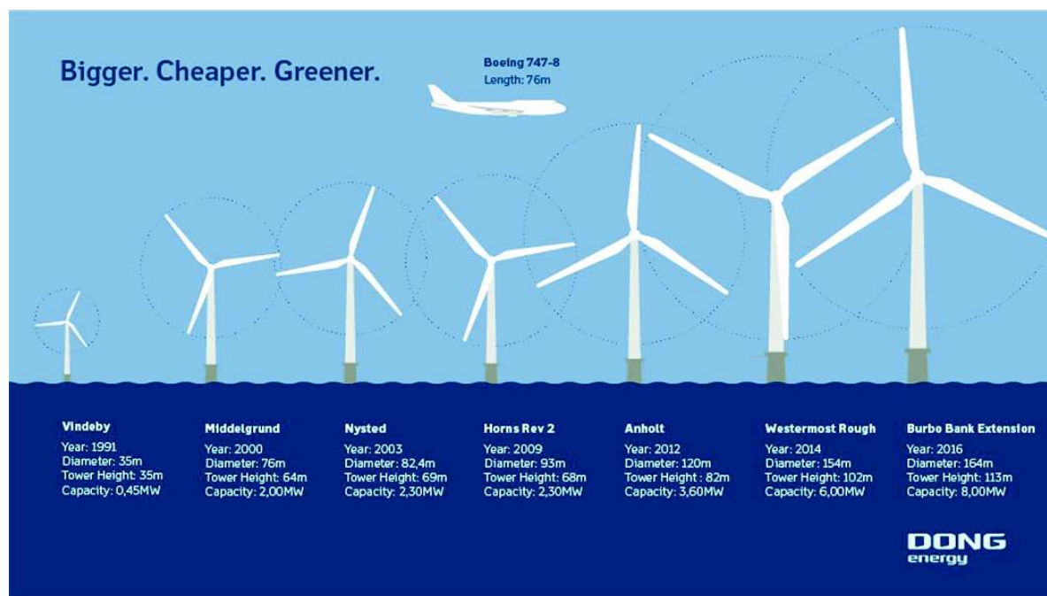
Figure 2: Illustration de l'augmentation constante de la puissance et taille des éoliennes en mer (source: Dong energy)
