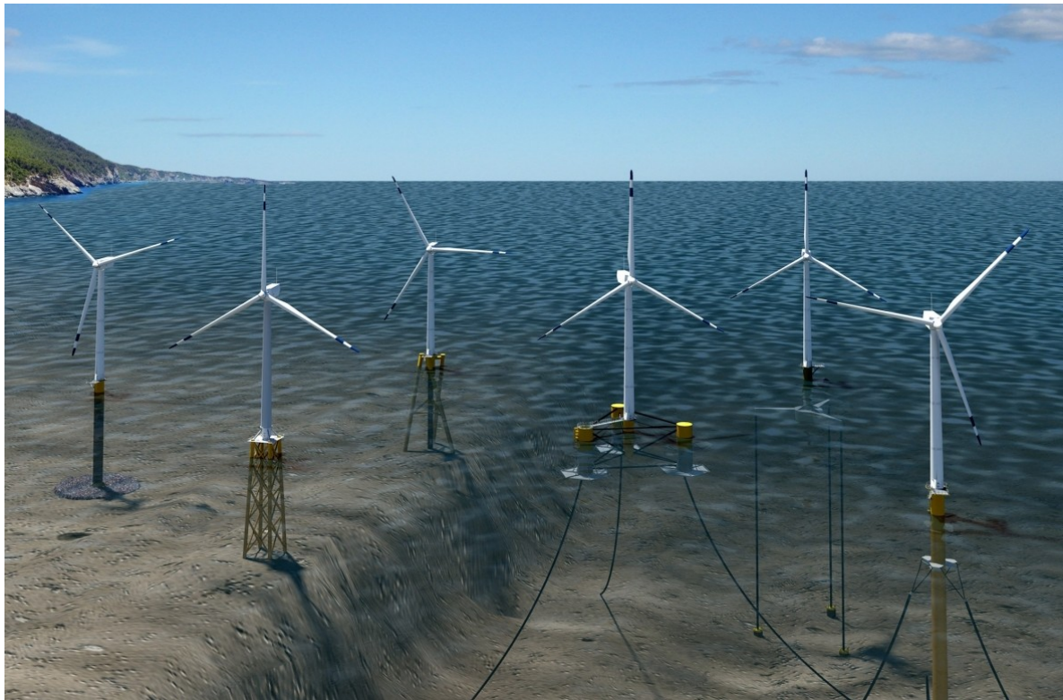
Figure 3 : Illustration de l'éolien posé et l'éolien flottant (source: Josh Bauer, National Renewable Energy Laboratory - NREL)
