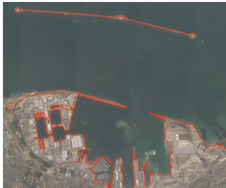
Illustration 9 : Exemple d'un ouvrage longitudinal éloigné du trait de côte – Secteur de Cherbourg
