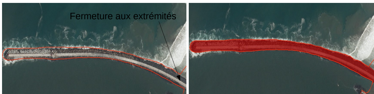
Illustration 11 : Réutilisation de la limite de laisse de mer pour transformer un ouvrage en polygone – Secteur à Tarnos
